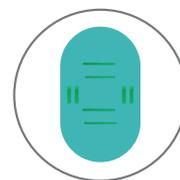
Lapidado (bordas arredondadas visando melhor acabamento e prevenção de acidentes com corte).
